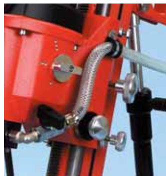
Direktni priključak vode za crijevo sa spojnicom. Spojnica Art.-Nr. 0708 651 705 Utični priključ. 1/4" Art.-Nr. 0708 651 706
