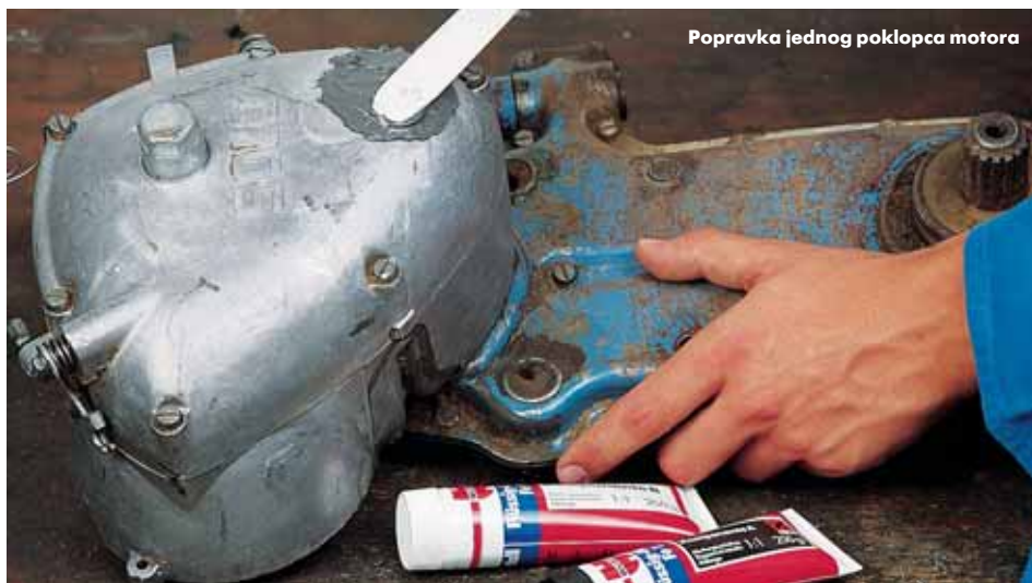
Ležište lagera, popravka i obrada.
