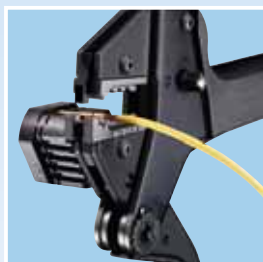
Primjena sa držačem kontakata
