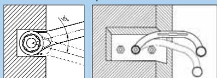
Oblik polumjeseca omogućuje rad na teško dostupnim navrtkama koje se ne mogu doseći uobičajenim alatima. Rad na bloku motora, starteru, usisnoj i izduvnoj grani.
