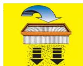
Ravni faltani filter će preko zračnih udara svakih cca. 15 sec. biti automatski očišćen (pulsiraći zvuk).
