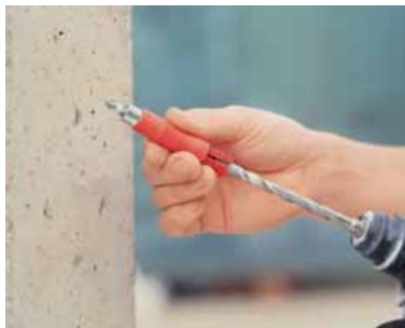
Jednostavno nataknuti držač bitsa na borer.
