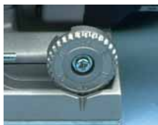
Dubina glodanja podesava se kočičkim na veličine 0, 10, 20, Simplex (S), Duplex (D) i Max.
