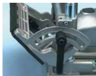
Zakretni graničnik za kontinualno podešavanje ugla rezanja. Glavni uglovi od 22,5°, 45° i 67,5° su brzopodesivi.
