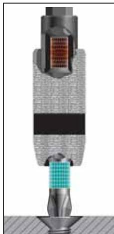
Funkcionalno ugrađena opruga u držaču bitsa apsorbuje vršna opterećenja: unutrašnjost držača bitsa se također neprimjetno okreće. Kada se prekorači snaga opruge, držač bitsa se tako podešava, da se mehanizam ne ošteći.
