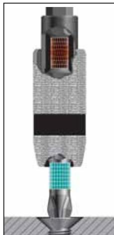
Sada u akciju stupa bits: Uz pomoć modernog procesa kaljenja i bits sada može u srednjem dijelu hvatati vršna opterećenja. Zbog toga dolazi do kasnijeg pucanja na vrhu bitsa, mnogo kasnije nego kod do sada poznatih bitseva za zavrtanje.
