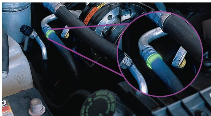
**Za pronalaženje malih napuklina u sistemima sa rashladnim sredstvom, vodenim hlađenjem, benzinskim i dizel motorima, mjenjačima brzina i servo upravljačima.**
