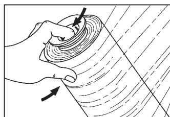
Za bolju zategnutost (napetost) folije, treba je voditi između palete i role. Dodatno se može odmjeranim pritiskom palca i kažiprsta na čahuraste držače povećati zategnutost (napetost) folije.
