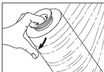
Nakon što kraj folije zavežete na jednom čošku palete, ona se može pod silom zatezanja omotati počevši odozdo prema gore. Upravljanje folijom pri omotavanju se vrši pomoću palca i prstiju.
