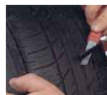
9. Nakon montaže gume i pumpanja, odsjeći višak bez povlačenja.
