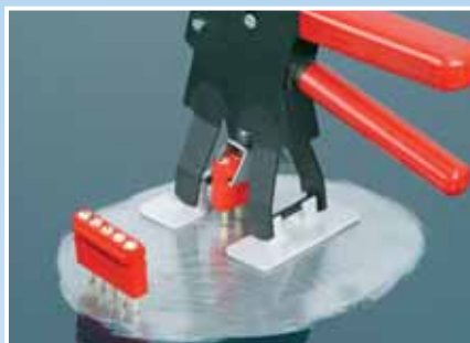
Goli čelični lim sa PinPuller elektrodama.
