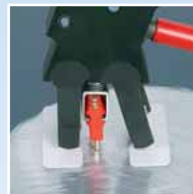
Različita pozicija krakova (nožica) za poravnanje uglova i visine.
