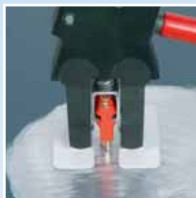
Usko naslanjanje za mala udubljenja i udubljene ogrebotine.
