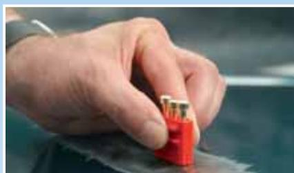
Vrhove elektroda postaviti na lim i izvlačni blok gurnuti prema dole.
