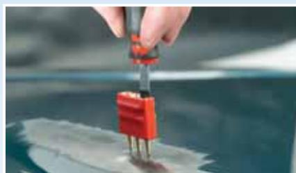
Okrenuti elektrode za 90° sa odvijačem Art.-Nr. 0613 251 065
