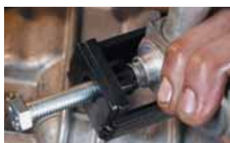
4. Usisni filter ravno uvrtnu u otvor voda niskog pritiska (usisni vod).
