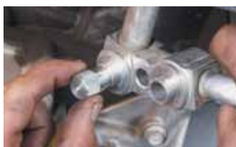
2. Pomoću mjerača veličine, na priključku utvrditi odgovarajuću veličinu filtera.
