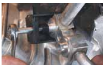
5. Pomoću okastog ključa, Art.-Nr. 0713 303 06, uvrtnu vijak ugradnog alata i tako filter utisnuti u usisni vod. Važno: usisni filter mora biti postavljen ravno ili malo ispod otvora.
