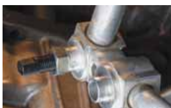
1. Pronaći u sortimentu alat koji odgovara postavljenom filteru i postaviti ga u otvor usisnog voda. Okrenite zatim vijak dok ne osjetite stezanje u otvoru. Sada okretati maticu u smjeru usisnog filtera. Sada navoj vijka uvrtnu u metalni prsten usisnog filtera.
