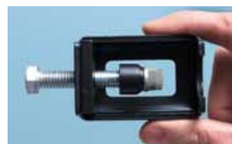
3. Odgovarajući filter namazati PAG-uljem i postaviti na trn za postavljanje.
