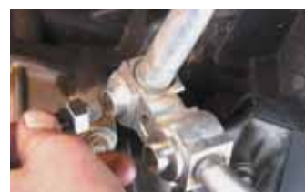
2. Nakon stezanja usisnog filtera u deinstalacioni alat, izvadite filter zajedno sa vijkom iz otvora.
