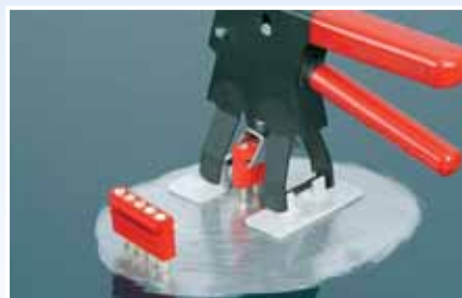
Goli čelični lim sa priborom za navarivanje.
