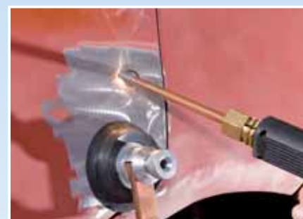
Uvlačenje sa ugljenom elektrodom
