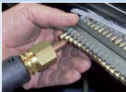
Zavarivanje PinPuller ® -elektroda
