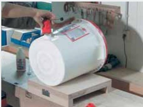
Kantu sa ljepilom položiti na bok. Izvuči otvor za postavljanje slavine i otvoriti ga. Skinuti sigurnosnu membranu. Zavrnuti slavinu za istakanje ljepila i uspraviti kantu sa ljepilom.
