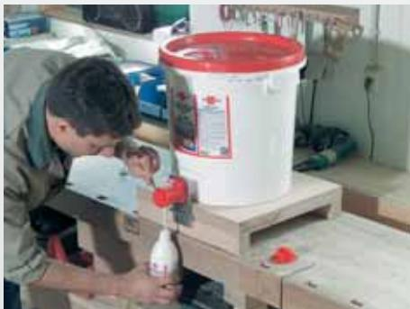
Zavrnuti ploču sa baglamom i podizanjem polugice (otvaranjem slavine) ljepilo može da se toči u bocu za ljepilo ili prihvativi rezervoar valjka za nanošenje ljepila.
