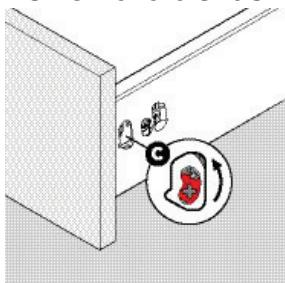
Odvijačem (poz.2) odvrnuti mehanizam za zaključavanje (C) na obje strane u smjeru strelice.
