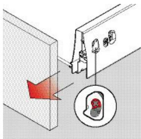
Blenda je otključana i može se izvaditi. Kod upotrebe spojeva blende i podaladice, iste otpustiti!
