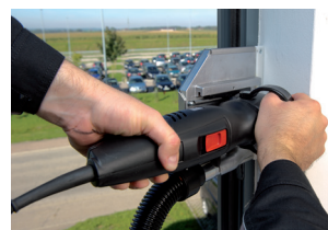
Rezač za žljebove može da radi pod uglom tokom rezanja tako da rezna linija leži neposredno iznad okvira prozora. Inače, udaljenost od starog prozorskog okvira je 7 - 8 mm. Idealno za okvire današnjih izoliranih staklenih prozora.
