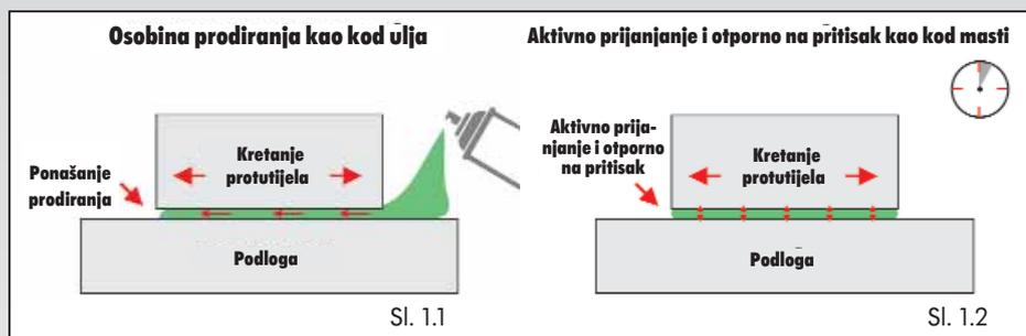
Dobro puzanje odmah nakon prskanja (sl. 1.1) omogućava penetraciju masti u najuže pukotine. Nakon kratkog isparavanja otapala ostaje žilava mast tačno na mjestu koje treba da se podmaže (sl. 1.2). Istovremeno se to mjesto prekriva zaštitnim slojem i štiti od korozije.
