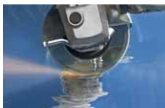
Brušenje sa Zebra lamelnom providnom brusnom pločom: dobra vidljivost obrade radnog komada.
