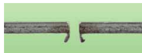
Za poređenje: Formiranje srha kod uobičajene 1,0 mm rezne ploče
