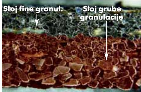
Povećana radna sigurnost zahvaljujući optimalnom prijanjanju zrna i optimalnom spajanju slojeva ploče.
