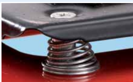
Opružna bazna ploča sprječava cijepanje keramičke pločice pri prelamanju.
