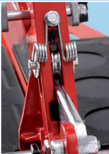
Poluga za rezanje i paranje na točkićima
