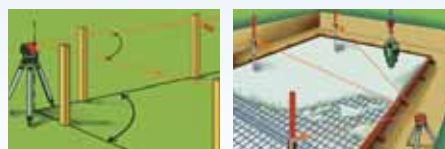
Postavljanje pravog ugla
