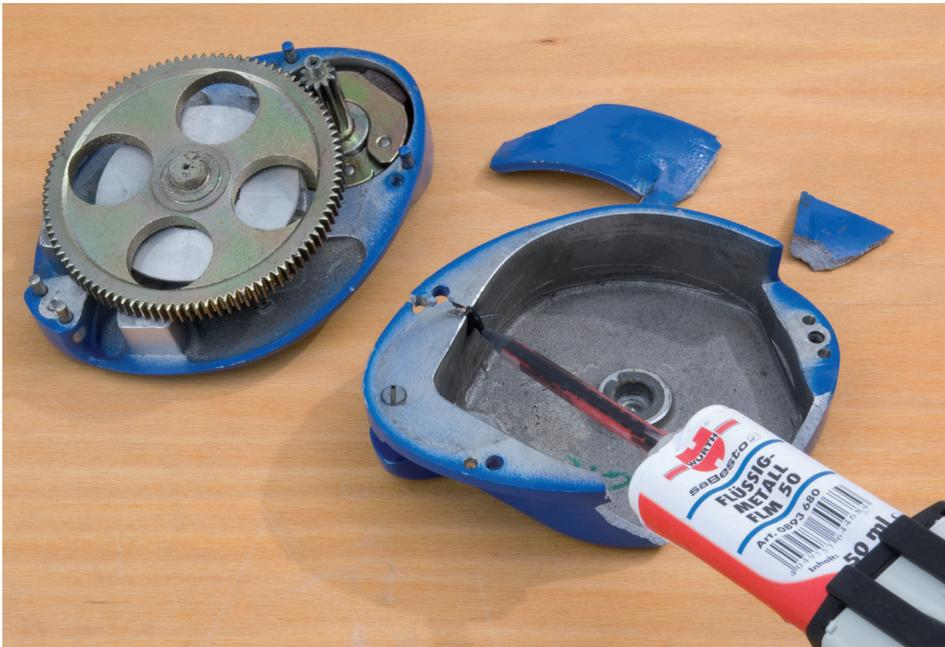
**Brzi reparaturni sistem za specijaliste i radionice u području obrade metala. Posebno namijenjen za zapunjavanje kalupa, zaptivanje i reparaciju pukotina.**
