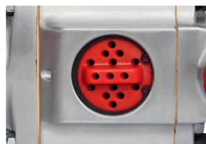
360° okretni izlaz zraka smješten na donjoj strani pneumatskog udarnog zavrtača. Izlazni zrak se može izbacivati u željenom pravcu.
