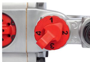
Prebacivanje smjera obrtanja udesno/ulijevo i četiri stepena obrtnog momenta pritezanja omogućuju optimalno prilagođavanje datoj primjeni.
