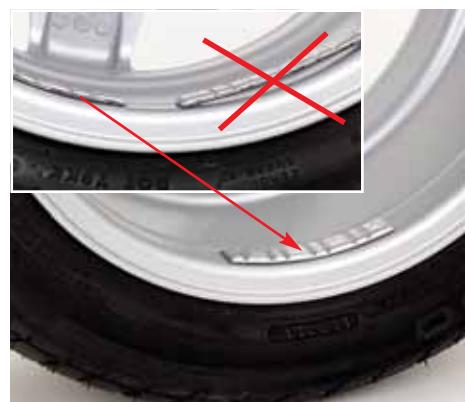
Očistite sve površine felge temeljno sa čistačem kočnica Art.-Nr. 0890 1087.
